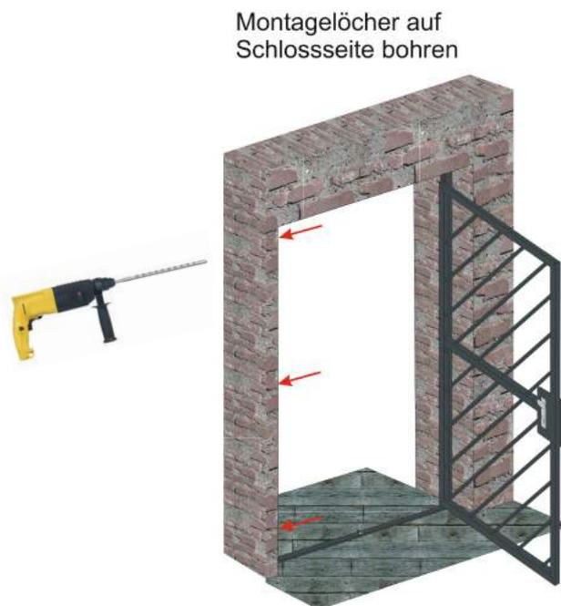
Nun schließen Sie das Türgitter so, dass die Anschlagbleche oben und unten auf dem Rahmen aufliegen. Jetzt fixieren Sie das Gitter in dieser Position, beispielsweise mit Holzkeilen. Öffnen Sie das Türgitter vorsichtig und markieren nun den unteren Befestigungspunkt auf der Schlossseite. Anschließend bohren Sie am unteren Punkt wie bereits bei den vorangegangenen Schritten das Montageloch und drehen die Schraube am fünften Befestigungspunkt ein.
