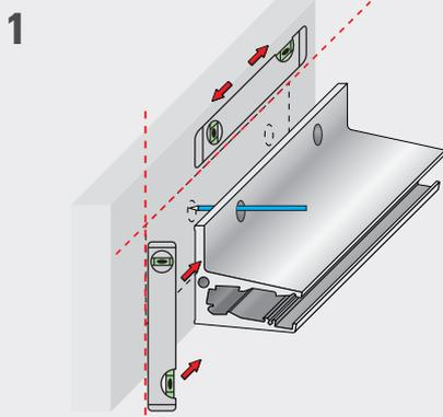
1 Richten Sie die Unterkonstruktion aus. Bestimmen Sie die Befestigungspunkte mit Hilfe des Profils.
